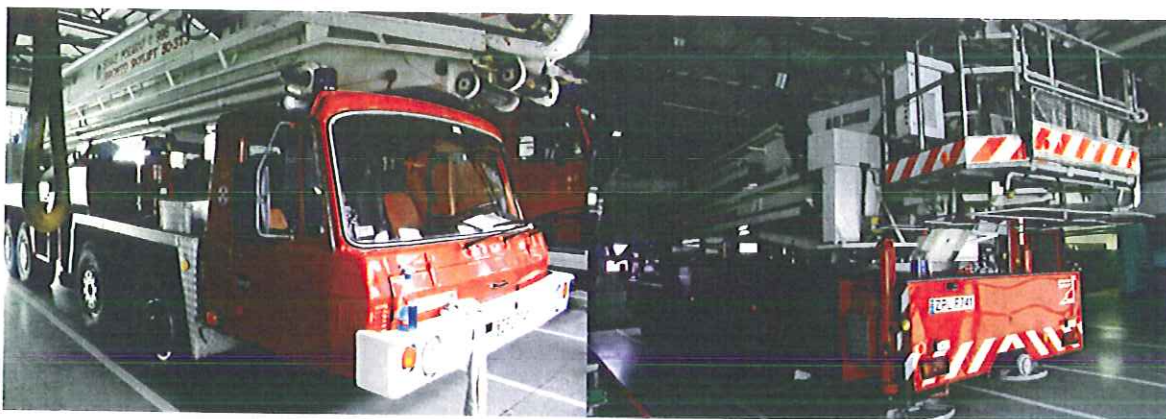
Samochód z podnośnikiem hydraulicznym o wysięgu 50 metrów na podwoziu TATRA.
