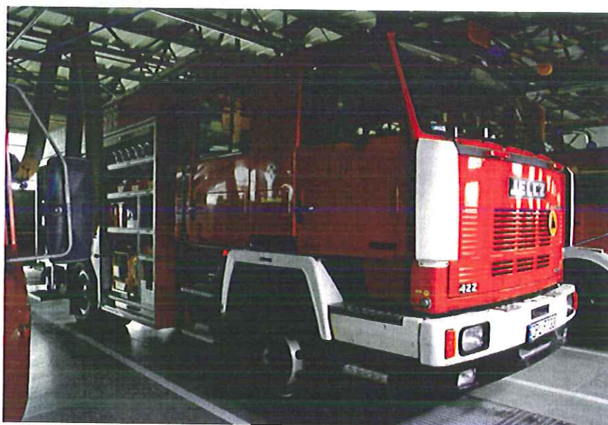
Samochód gaśniczy Jelcz wyposażony w zbiornik wodny o pojemności 2,5 \text{ m}^3 wody i 2,5 \text{ m}^3 środka pianotwórczego, autopompę o wydajności 2400 \text{ l/min.} i sprzęt do rat. technicznego.
