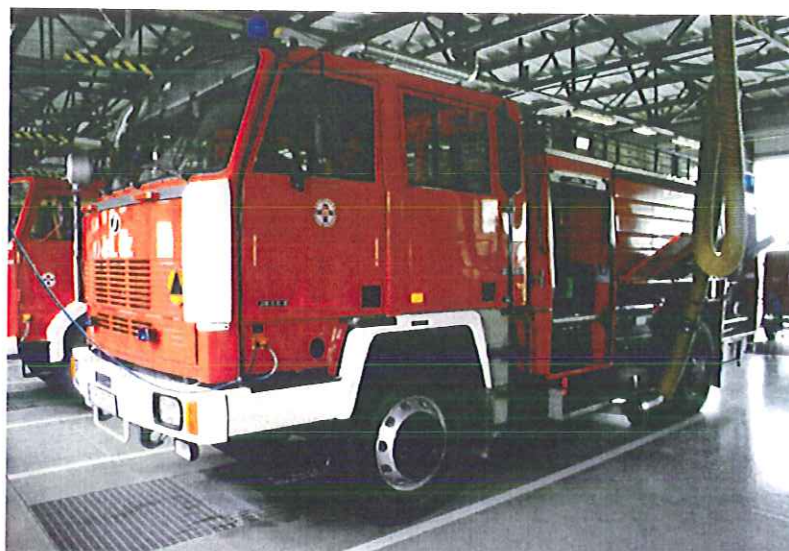
Samochód gaśniczy Jelcz, przewożący 4 m 3 wody oraz 1,5 m 3 środka pianotwórczego z autopompą o wydajności 2400 l/min.
