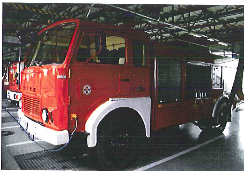
Samochód gaśniczy proszkowy ze zbiornikiem o pojemności 3000 \text{ kg} proszku gaśniczego.
