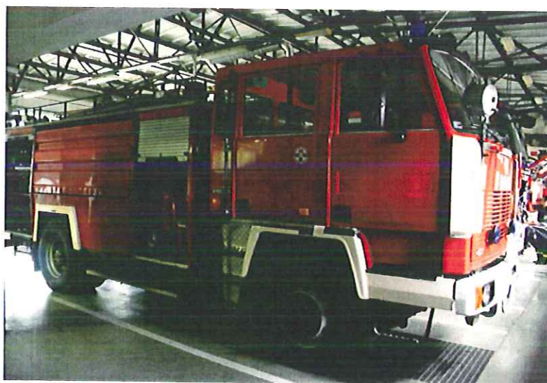
Samochód gaśniczy Jelcz, przewożący 5 m 3 wody z autopompą o wydajności 2400 l/min.
