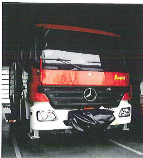
Samochód gaśniczy Mercedes, przewożący 5 m 3 wody i 5 m 3 środka pianotwórczego z autopompą o wydajności 6000 l/min.
