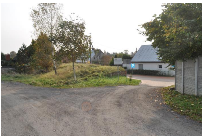
Fot. 3 Skrzyżowanie w km 0+256,54 (skrzyżowanie należy wykonać z kostki betonowej w stylistyce zgodnej z nawierzchnią istniejącą w ciągu drogi gminnej 195023Z)
